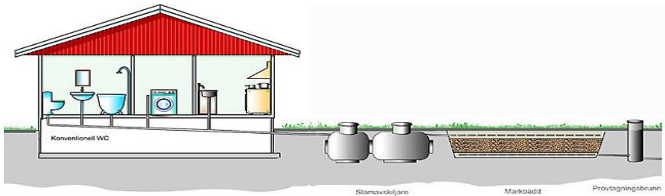
Bild: Principskiss på markbädd ( www.avloppsguiden.se )
