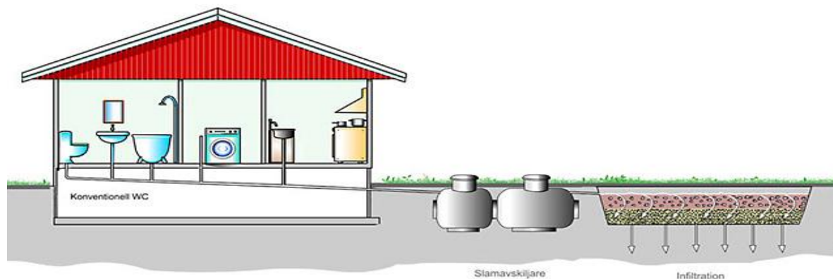
Bild: Principskiss för infiltration ( www.avloppsguiden.se )
